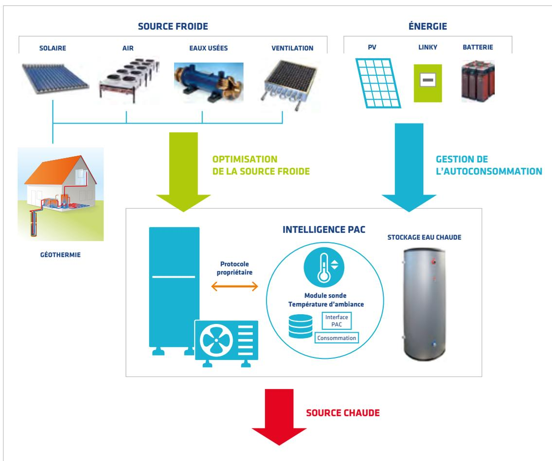
Au niveau énergétique, la pompe à chaleur doit être le cœur d'un concept global, compact, prêt à fonctionner, pour assurer d'une façon efficace les besoins de chauffage et/ou rafraîchissement (confort d'été), eau chaude sanitaire du bâtiment, en particulier la maison individuelle neuve ou rénovée, le bâtiment résidentiel.
