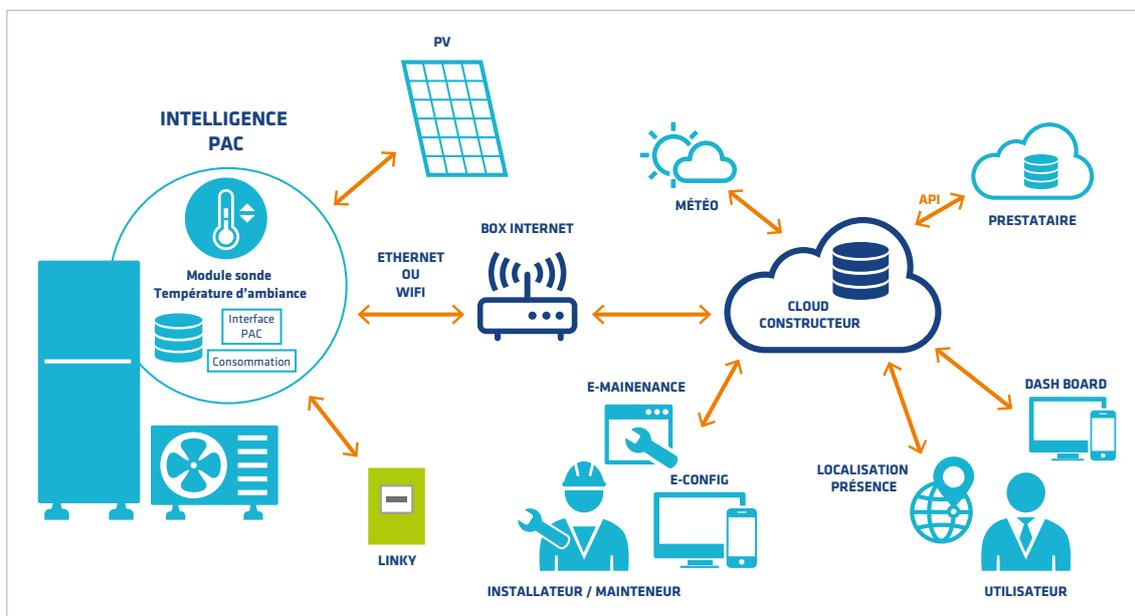
Une PAC connectée est composée physiquement de plusieurs modules communiquant entre eux pour assurer la régulation de température intérieure du logement : liaison entre le module d'ambiance et la PAC (liaisons filaires ou radio) et nécessairement liaison vers internet.
