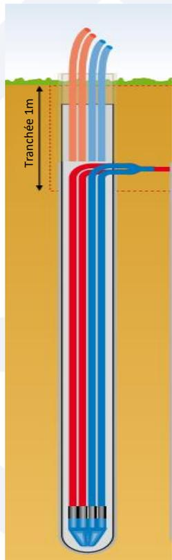
Forage réalisé entre 50 et 200m de profondeur
