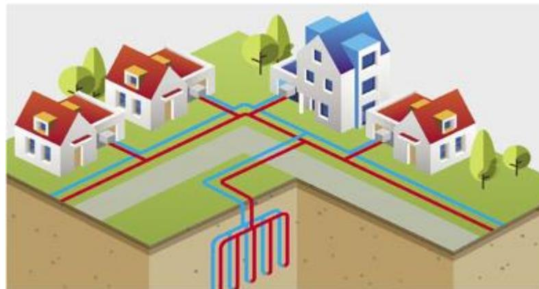
Mutualisation du captage par sondes géothermiques via une boucle tempérée
